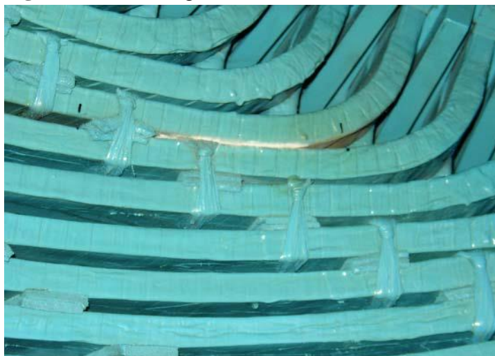
Figura 2.9 – Descarga entre bobinas de fases diferentes.
